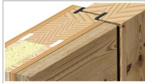
Detail: Standard-Türblatt Rohling mit Massiv-Altholz Applikation
